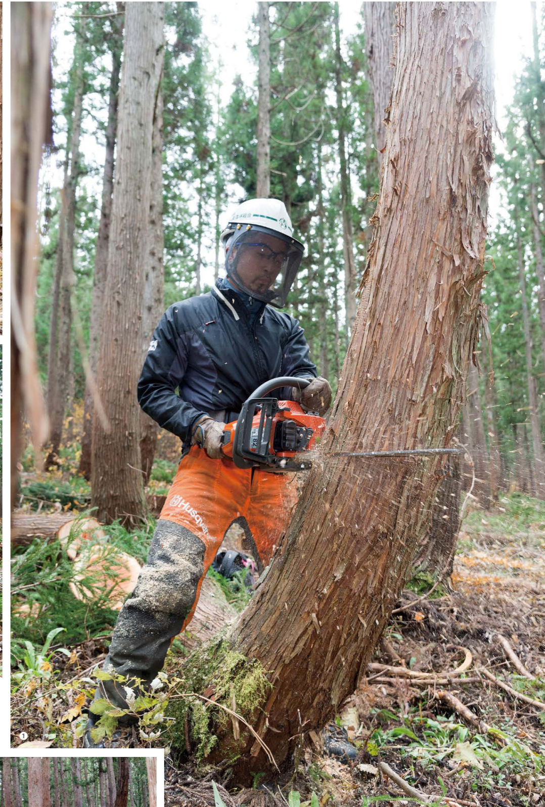
①チェーンソーで木を切る八重沢徹さんは入社1年目。10ページのチェーンソー研修にも参加している ②安全に確実に伐倒するためにはくさびの使用は欠かせない。ハンマーで打ち込んで伐倒する ③倒した木を一定の間隔で玉切りしていく ④今日の現場は1.3ヘクタール。根曲がりの木が多いのは豪雪地帯ならではの
